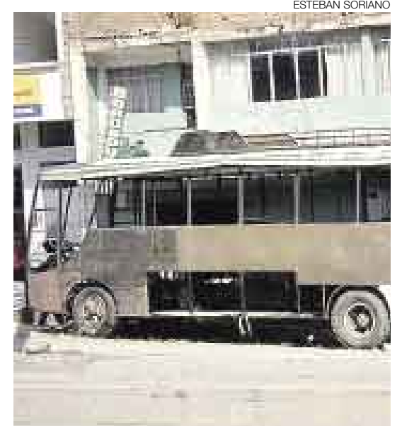
ESTEBAN SORIANO SIN CONTROL. El chasis del camión es revestido con planchas de metal. Luego se sueldan los asientos.
