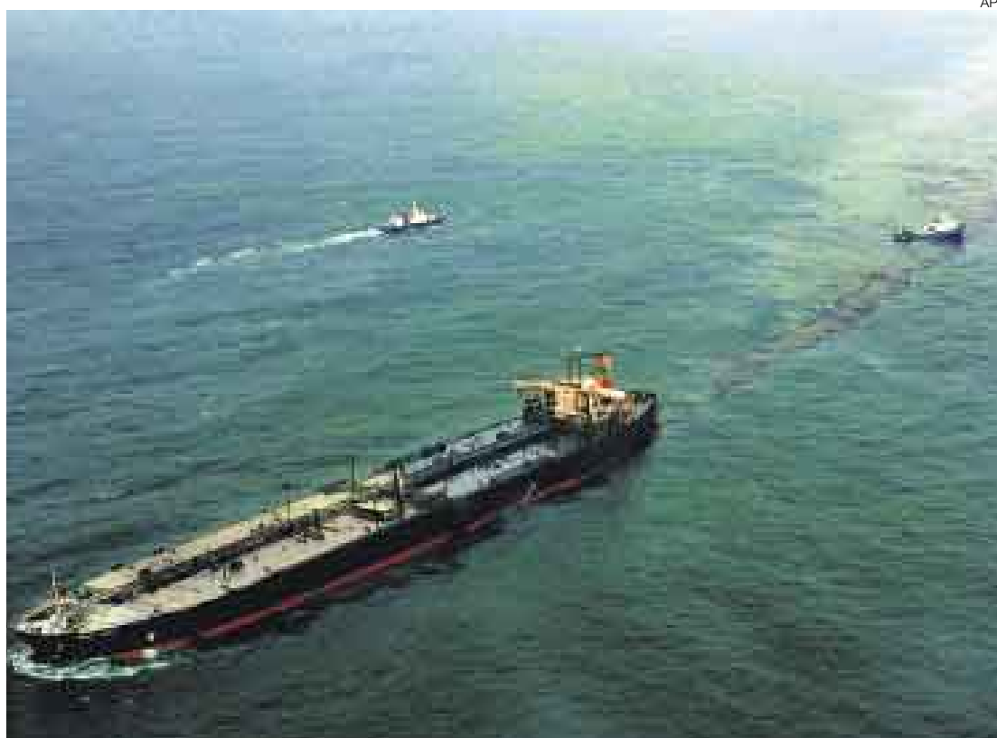
ESTELA MORTAL. El barco petrolero Hebei Spirit, de Hong Kong, fue chocado por una barcaza que transportaba una grúa. El temporal habría hecho caer la grúa sobre el barco y, tras perforarse, se inició el derrame.
