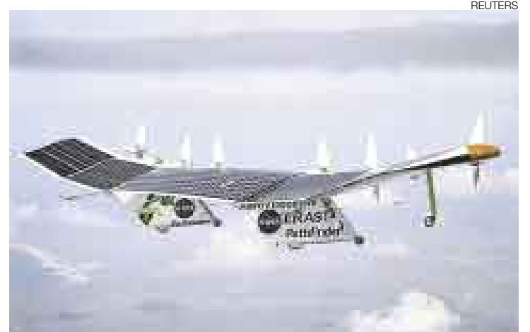
PIONERO. La NASA ya cuenta con un prototipo (Pathfinder Plus) diseñado para fotografiar campos de cultivo con la ayuda de paneles solares.
