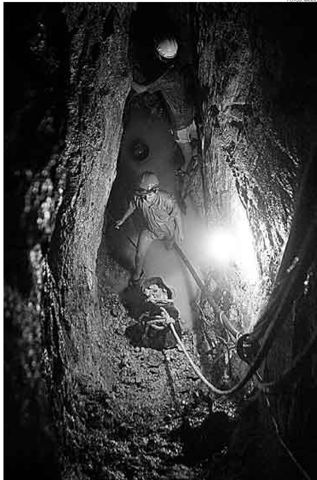
TODO DEPENDE DE UNA CUERDA. En busca del oro, los mineros informales descienden varios metros de altura, sin ayuda de escaleras o andamios. Su vida pende de una cuerda. Ellos trabajan desprovistos de botas y guantes.
